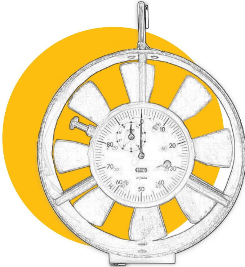
**Anemometro ad elica per la misurazione di velocità e portata dell'aria**
